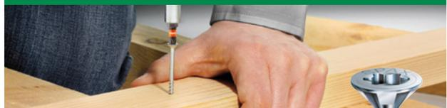
Verschraubung von Platten an Balken. Der gewindefreie Teil muss mindestens so lang sein wie die Materialdicke.
