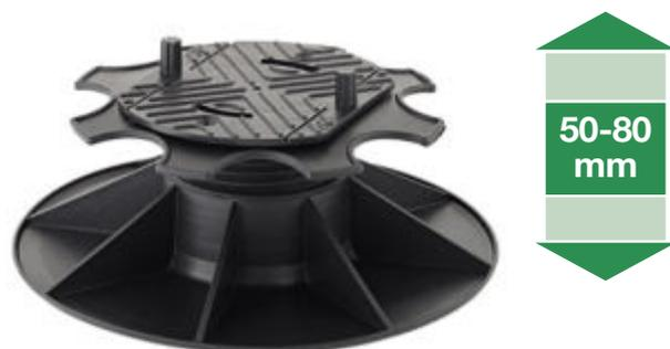
Verarbeitungshinweis: Bei der Verwendung von SPAX Lift Extension reduziert sich die Tragfähigkeit des SPAX Lift 3,5/5 und des SPAX Lift 5/9 von 800 kg auf 400 kg. Bei der Verwendung von SPAX Lift Extension in Kombination mit dem SPAX Free Lift reduziert sich die Tragfähigkeit nicht.
